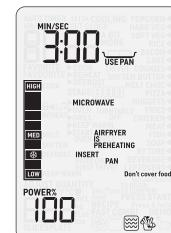
Al finalizar el ciclo de precalentado de 3 minutos, se emitirá una alerta sonora y la pantalla mostrará el mensaje "INSERT FOOD ON PAN" para indicar que el molde está listo para colocar los alimentos. Abra la puerta para colocar la comida sobre el molde y presione START para continuar.
