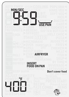
A la mitad del programa de cocción, el horno emitirá un pitido y el mensaje "STIR/TURN" parpadeará en la pantalla para indicar que debe revolver o dar vuelta la comida. Abra la puerta o pause presionando STOP/CLEAR (Detener/Borrar) una vez. Dé vuelta los alimentos y presione START para reanudar el ciclo.
