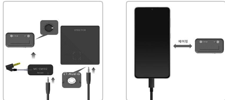
1 XCAL-Solo III와 MOS Kit, BT-Transceiver II를 연결 합니다.
