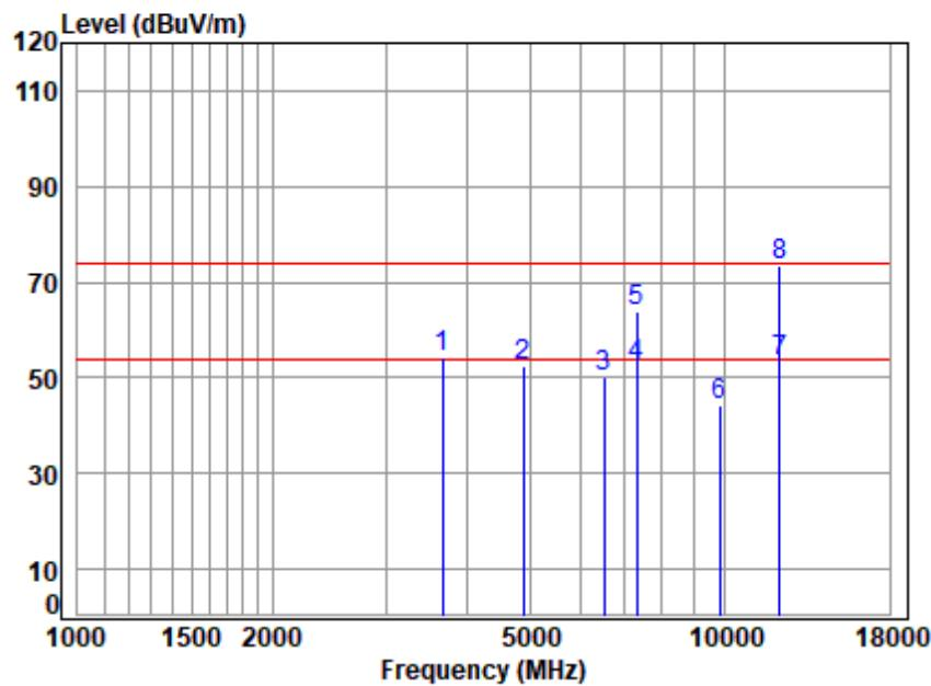
**Condition: 3m HORIZONTAL****Job No : 04038AT****Mode : 2440 TX RSE****: BLE 1M**
