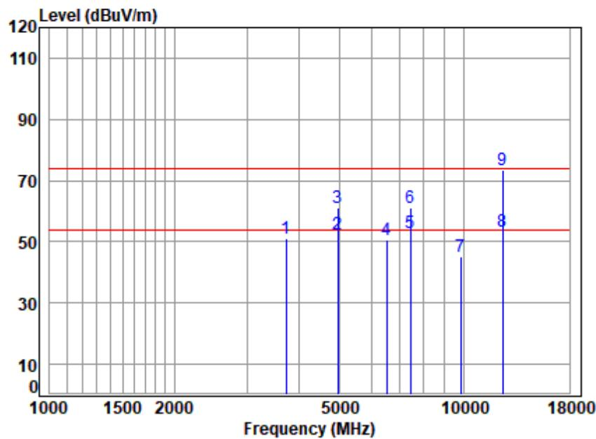
**Condition: 3m HORIZONTAL****Job No : 04038AT****Mode : 2480 TX RSE****: BLE 1M**
