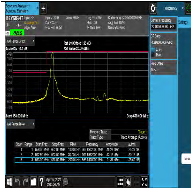
Band71 15MHz QPSK 133197 1RB#0
