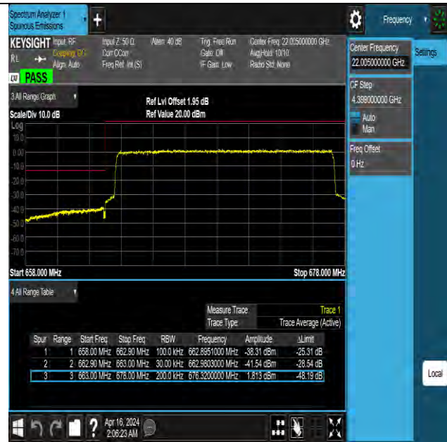
Band71 15MHz QPSK 133197 75RB#0
