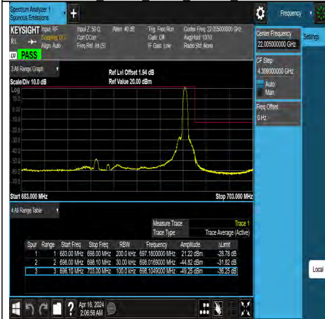
Band71 15MHz QPSK 133397 1RB#74
