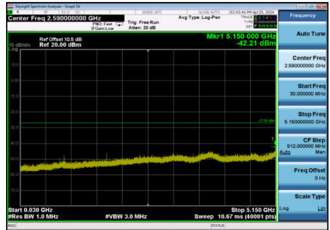
U-NII-1 ,Plot 2,30MHz~5150MHz-802.11a c(20MHz),5240MHz,Ant1
