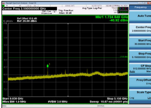
U-NII-1 ,Plot 2,30MHz~5150MHz-802.11a c(20MHz),5220MHz,Ant1
