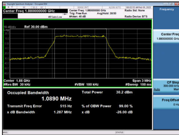
Band2-3MHz-QPSK-18900-15RB#0-PASS
