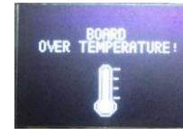
当电机运行温度高于100°C或低于0°C时，遥控器震动一次，遥控器屏幕提示过温，电机将停止工作。
