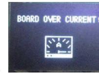
当电机运行电流超过允许值，遥控器屏幕提示过流，电机将停止工作。
