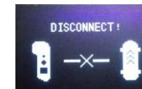
当信号突然丢失时，遥控器屏幕提示已断连，并伴随短震一次，若滑板正在进行加速操作，首先加速会慢慢停止，然后自动缓慢刹车；若没有进行加速操作，滑板将缓慢刹车。信号丢失后，遥控器将进入搜寻滑板设备状态，搜到并重新连接成功后遥控器短震一次，缓慢刹车取消，立即恢复正常操作。
