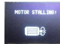
当电机堵转或完全卡死时，遥控器持续间歇式的短震，遥控器屏幕提示电机发生堵转。发生此情况后使用者应该停止运行滑板，查看电机是否有异物卡住，并及时清除后方可运行滑板。
