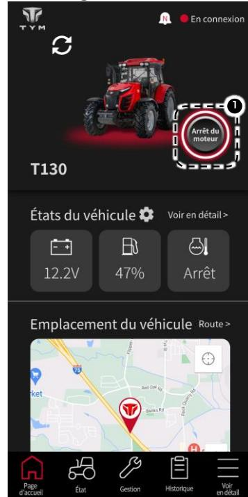
Si l'icône de d'Arrêt du moteur<sup>①</sup> est noire avec « DÉMARRER », le moteur s'est arrêté et vous pouvez ordonner au moteur de démarrer après avoir entré le mot de passe simple.
