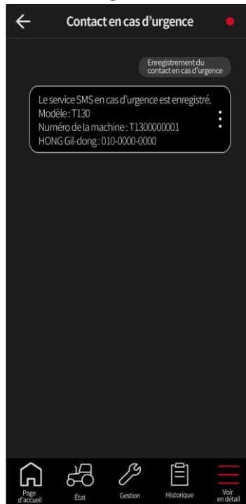
En cas de renversement du véhicule, une alerte d'urgence est envoyée au contact d'urgence enregistré et un SMS au centre de service/revendeur.
