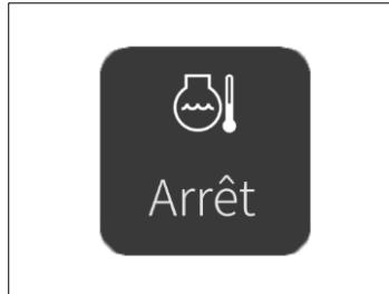
La température du liquide de refroidissement s'affiche au démarrage du moteur. Lorsque le moteur s'est arrêté, la température du liquide de refroidissement s'affiche comme « OFF ».
