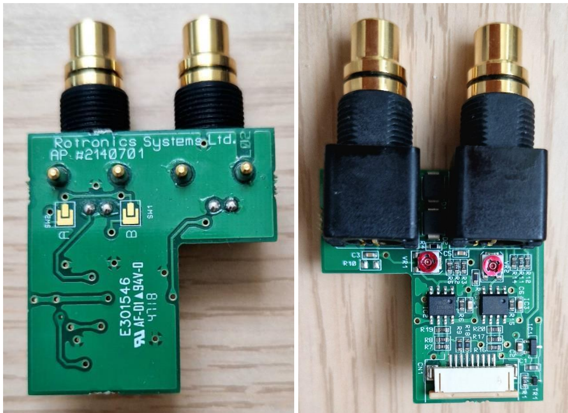
GENII/FRZ/200 Sensor interface PCBA
