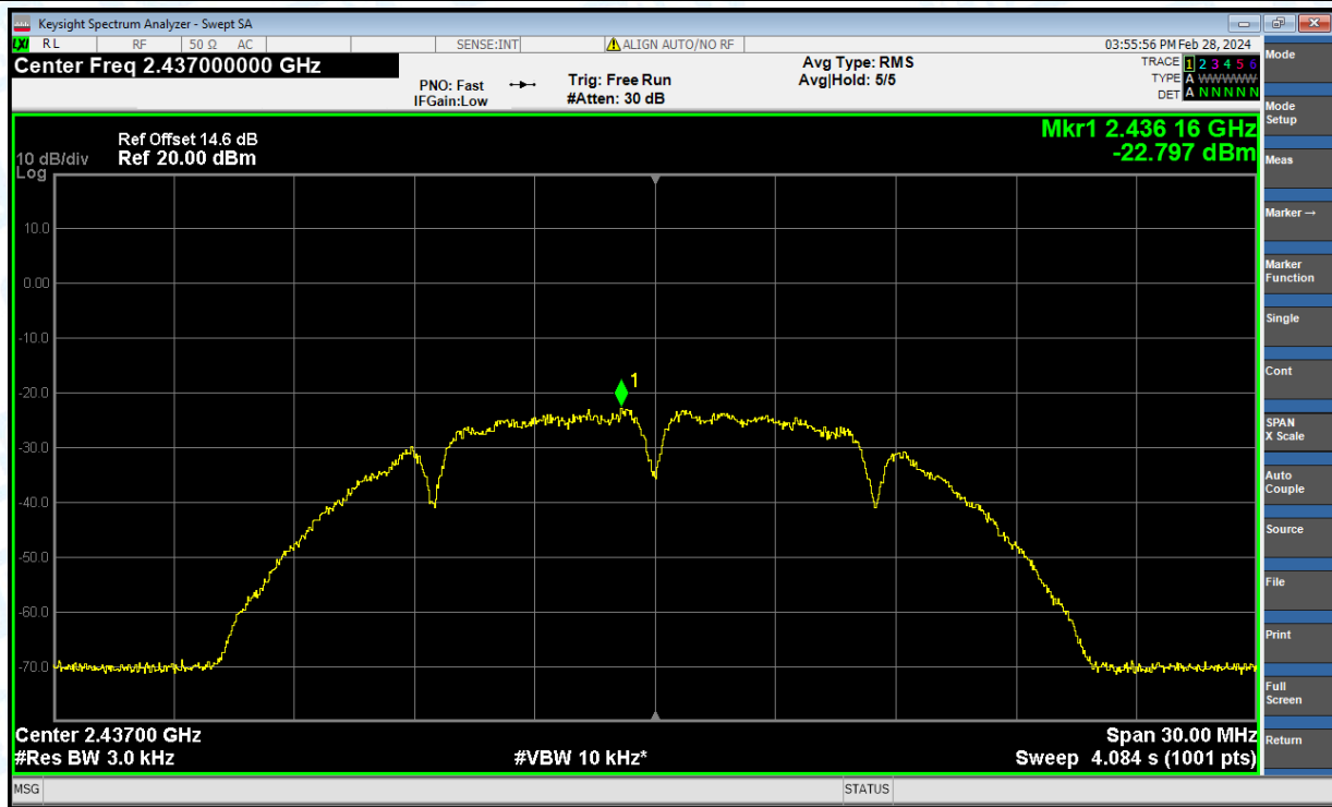
PSD NVNT b 2437MHz Ant1
