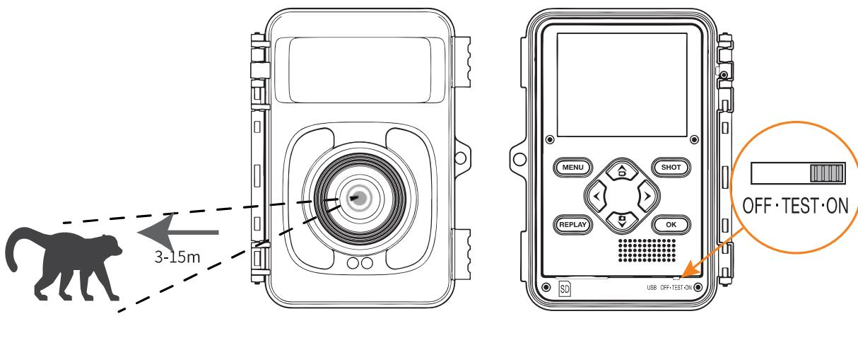
**ご注意：**不要な写真を撮ることを防ぐために、レンズを太陽の当たる方向に向けないことをお勧めします。カメラの高さを確認する観察されるエリアと一致しているかどうかを確認してください。無関係なトリガーを避けるために、カメラを木の枝の近くに設置しないでください。
