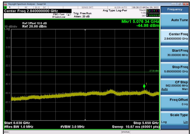
U-NII-3 ,Plot 2,30MHz~5650MHz-802.11a c(20MHz),5745MHz,Ant1
