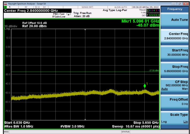
U-NII-3 ,Plot 2,30MHz~5650MHz-802.11a c(20MHz),5825MHz,Ant1
