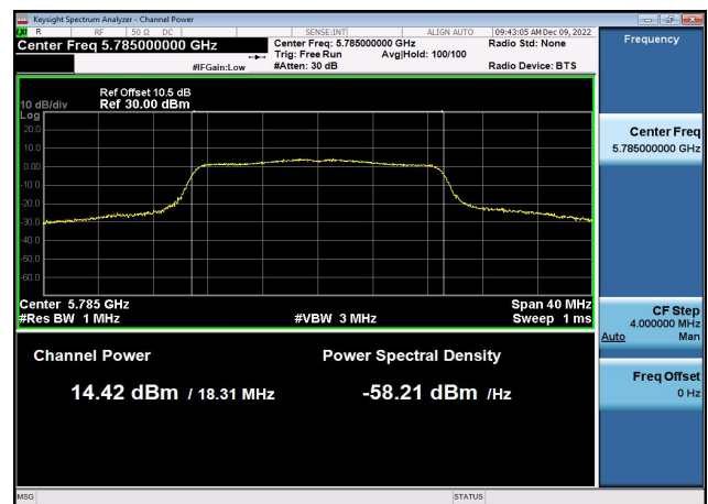
U-NII-3 Output Power-802.11ac(20MHz) ,5785MHz,Ant1
