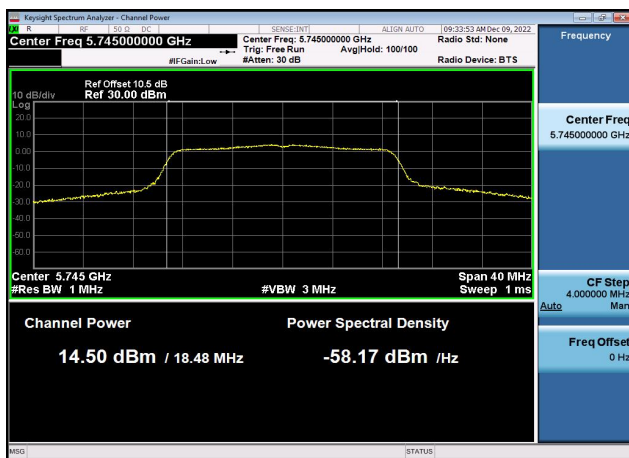
U-NII-3 Output Power-802.11ac(20MHz) ,5745MHz,Ant1
