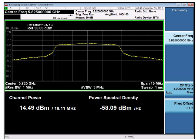
U-NII-3 Output Power-802.11ac(20MHz) ,5785MHz,Ant1
