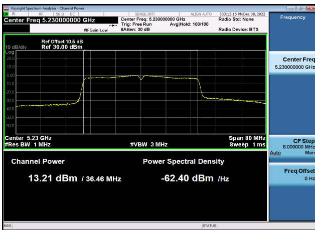
U-NII-1 Output Power-802.11n(40MHz) ,5230MHz,Ant1
