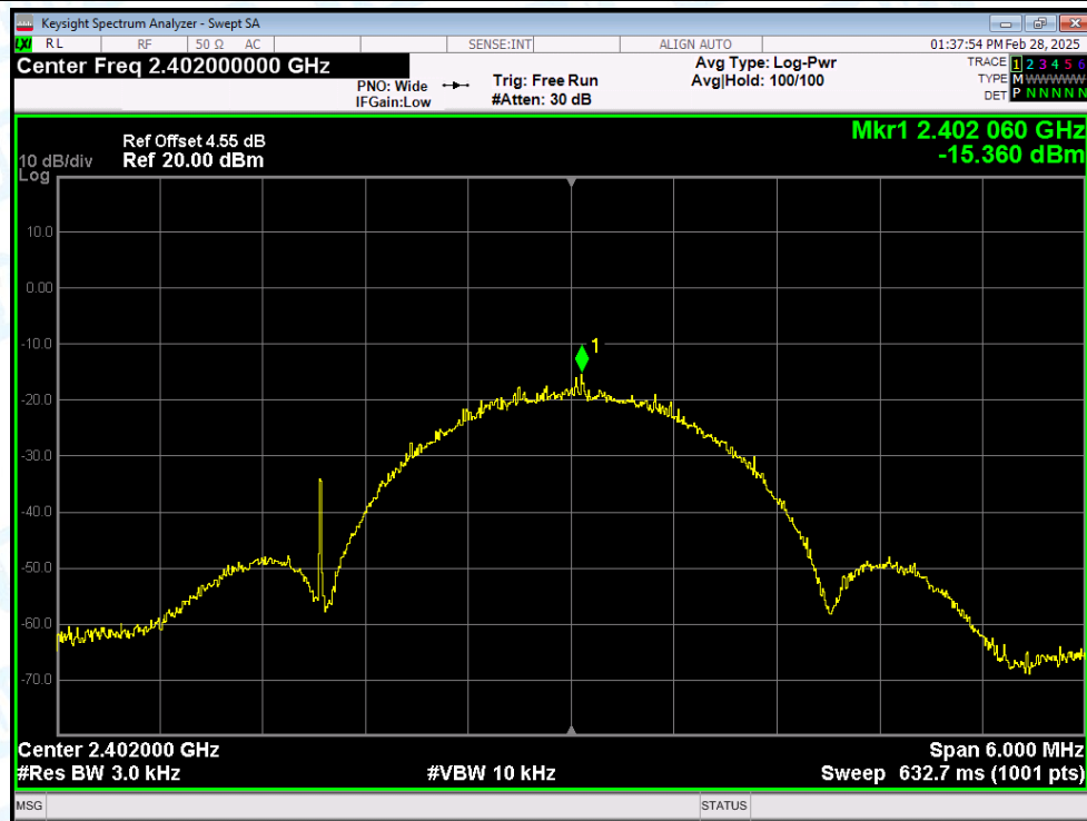
PSD NVNT BLE 2Mbps 2402MHz Ant1
