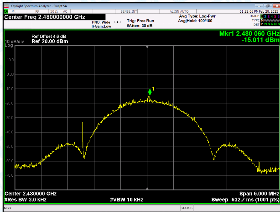
PSD NVNT BLE 2Mbps 2480MHz Ant1
