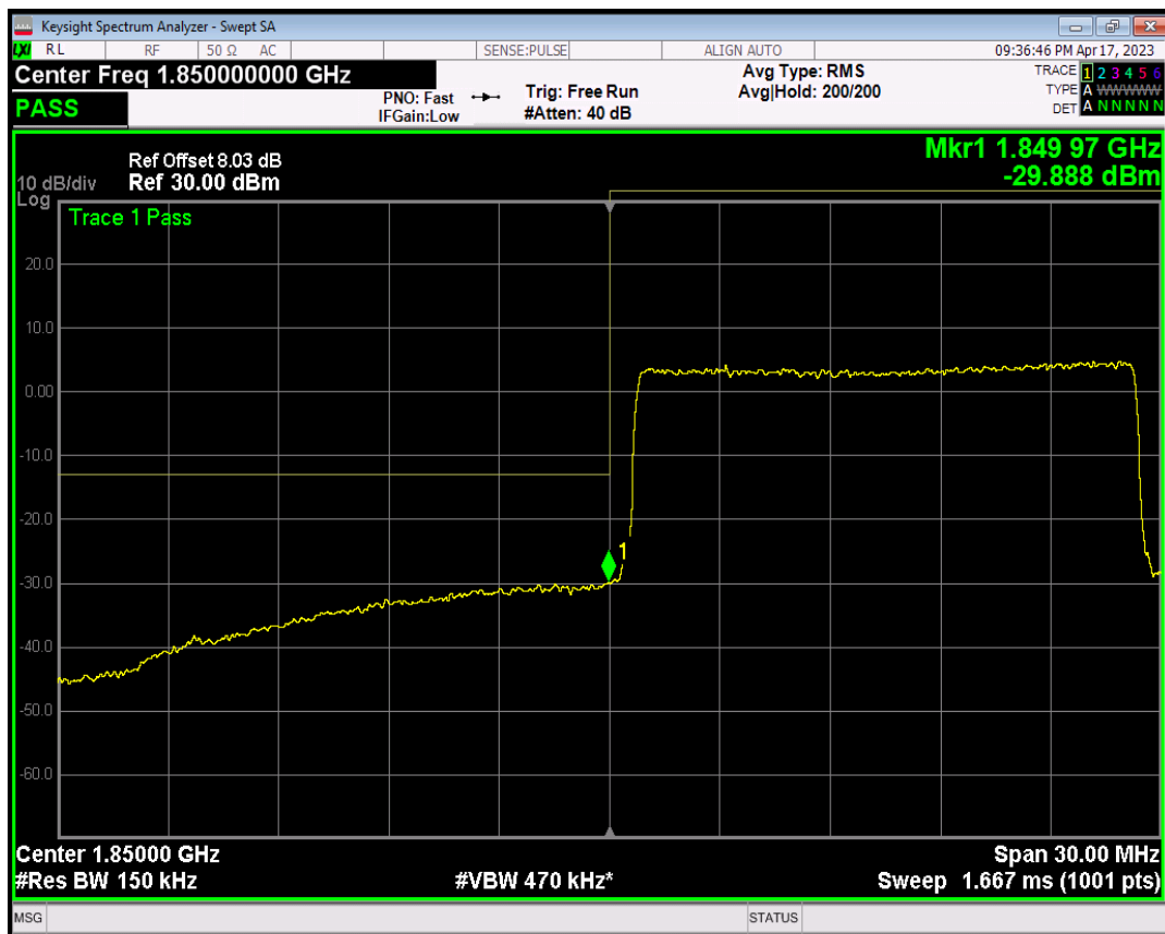
Band2 QPSK BW=15MHz Channel=19125 RB Size=1 Position=#0
