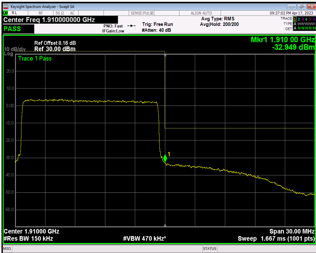
Band2 QPSK BW=20MHz Channel=18700 RB Size=1 Position=#0
