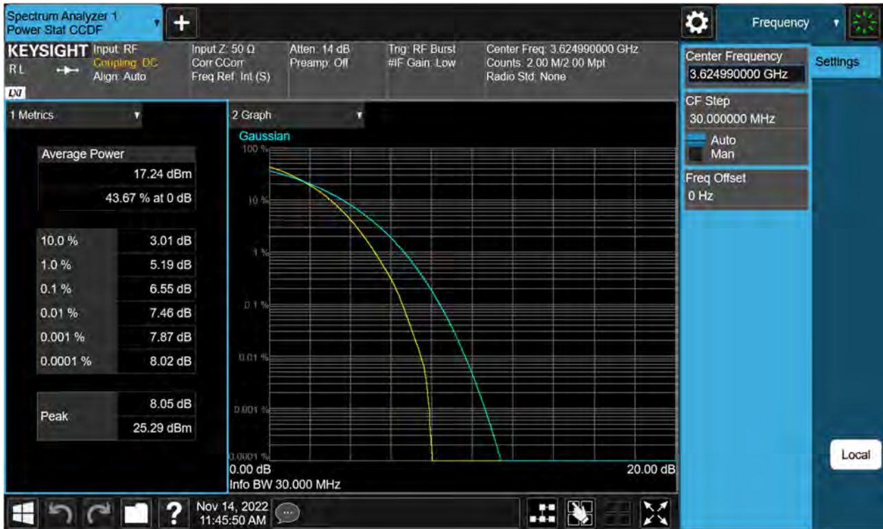
Sub6 n48. PAR Plot (30 MHz Ch.641666 256-QAM RB 75)
