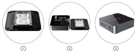
1.本機の底面カバーを外し、底面カバーのペイにハードディスクを取り付ける。
