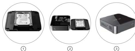
1. Retirar a tampa inferior da máquina e instalar o disco rígido em a baía da tampa inferior.
