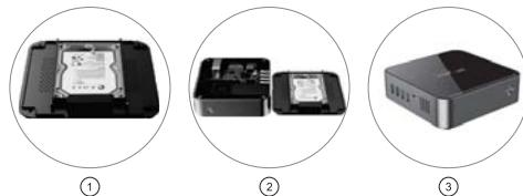
1. Entfernen Sie die untere Abdeckung des Geräts und installieren Sie die Festplatte in den Schacht der unteren Abdeckung.
