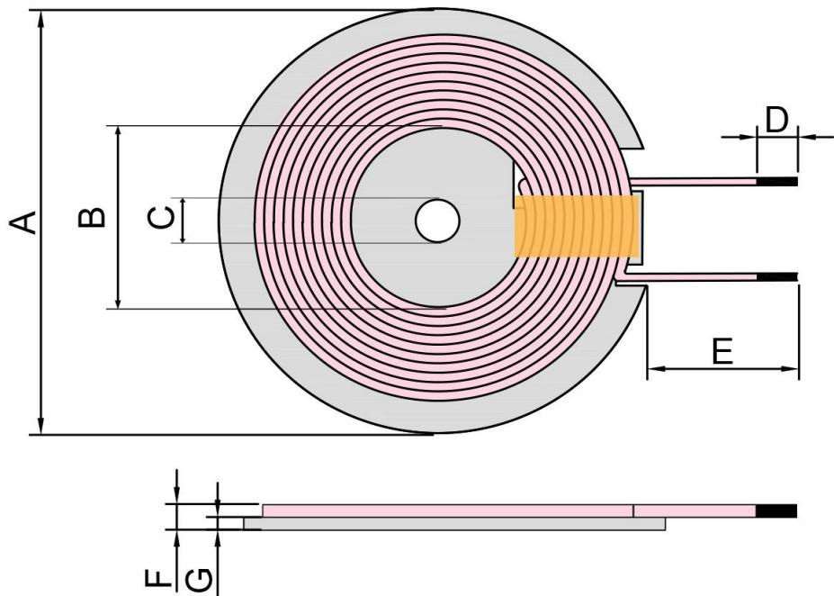
备注 Note: 1.磁片材质铁氧体硬磁, 带背胶; 2.高温胶宽度8mm;
