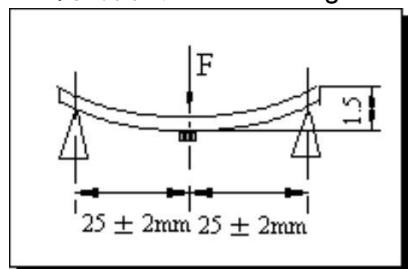
将产品按图焊在  $1.6 \pm 0.2$ mm 的 PCB 板中间，由箭头方向施力 :  $1\text{mm/S}$  , 弯曲距离 :  $1.5\text{mm}$  , 保持  $5 \pm 1\text{S}$  , 产品金属层无脱落。
