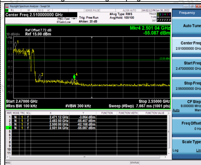
Right Band edge hopping on
