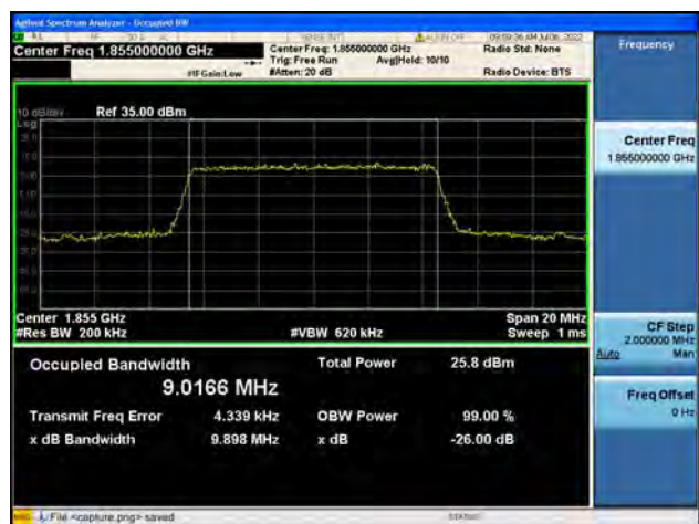
B2 / 10MHz / QPSK/ Mid CH
