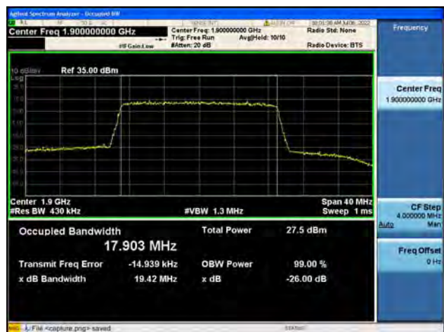
B2 / 20MHz / QPSK/ High CH
