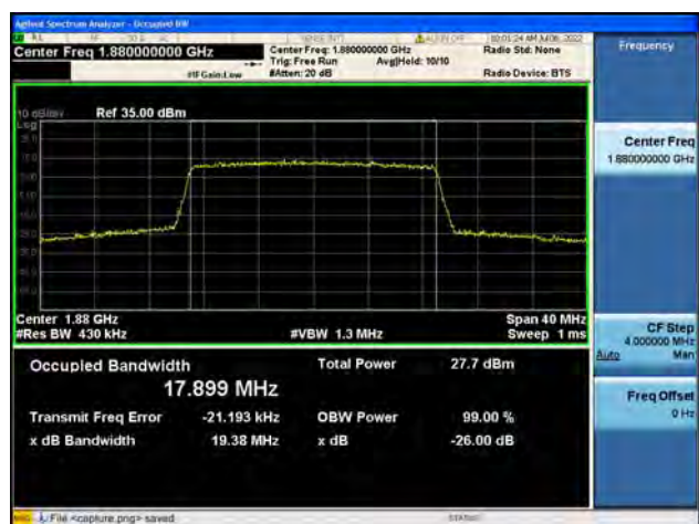
B2 / 20MHz / QPSK/ High CH
