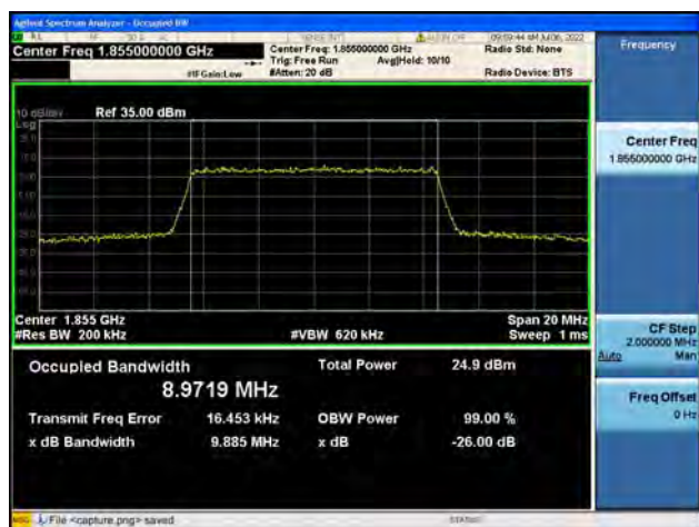
B2 / 10MHz / 16QAM/ Mid CH
