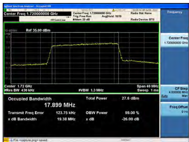
B4 / 20MHz / QPSK/ Mid CH
