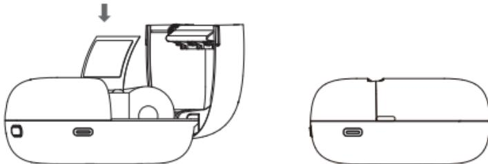
△ 打印纸只有一面能打印，请正确摆放打印纸的方向。
