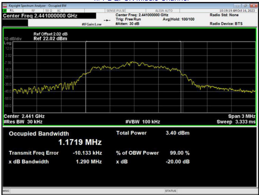
\pi/4 -DQPSK Middle Channel
