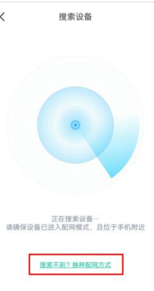
(5) 搜索设备 方式 2：如未搜索到设备，点击下方提示，使用二维码配网
