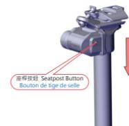
若要降低座桿，請按壓並釋放座桿按鈕一次，然後用手向下按壓座墊。座墊達到所需的壓縮位置時請停止下壓，然後按壓按鈕第二次，從而將座桿鎖定在此位置。第二次按壓按鈕之前，請勿移除座墊所承受的作用力。
