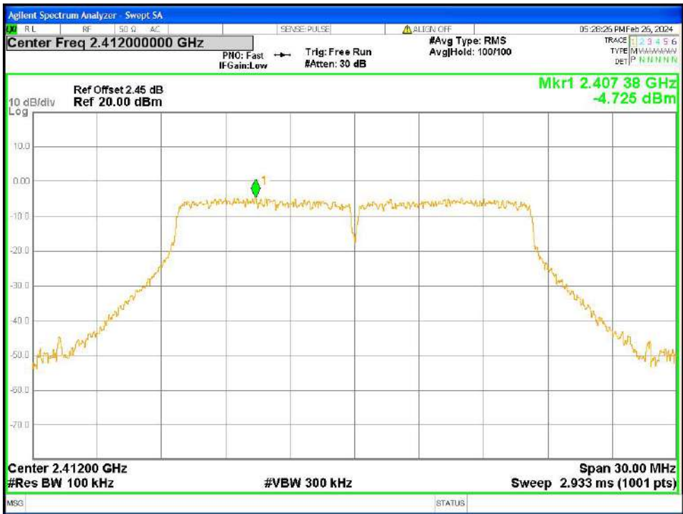
Band Edge NVNT g 2412MHz Ant0 Ref
