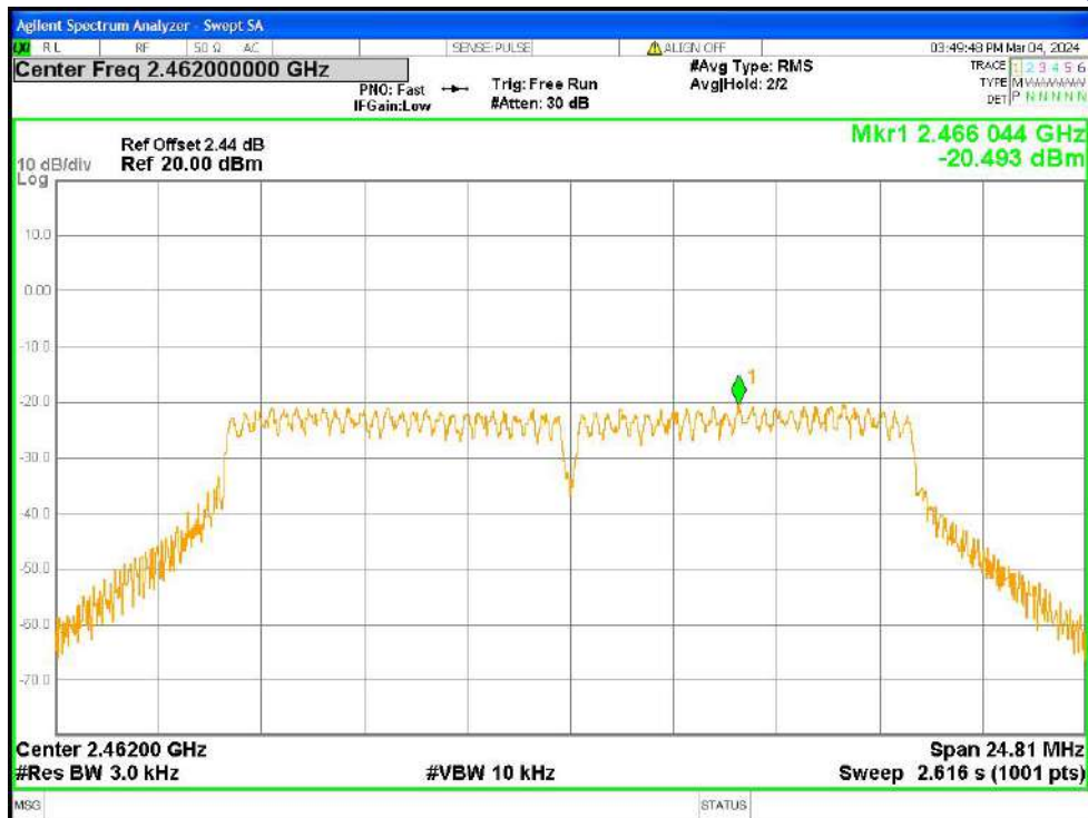
PSD NVNT g 2462MHz Ant1
