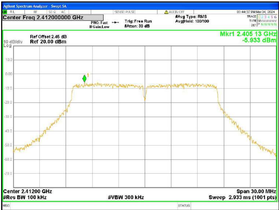
Band Edge NVNT g 2412MHz Ant1 Ref
