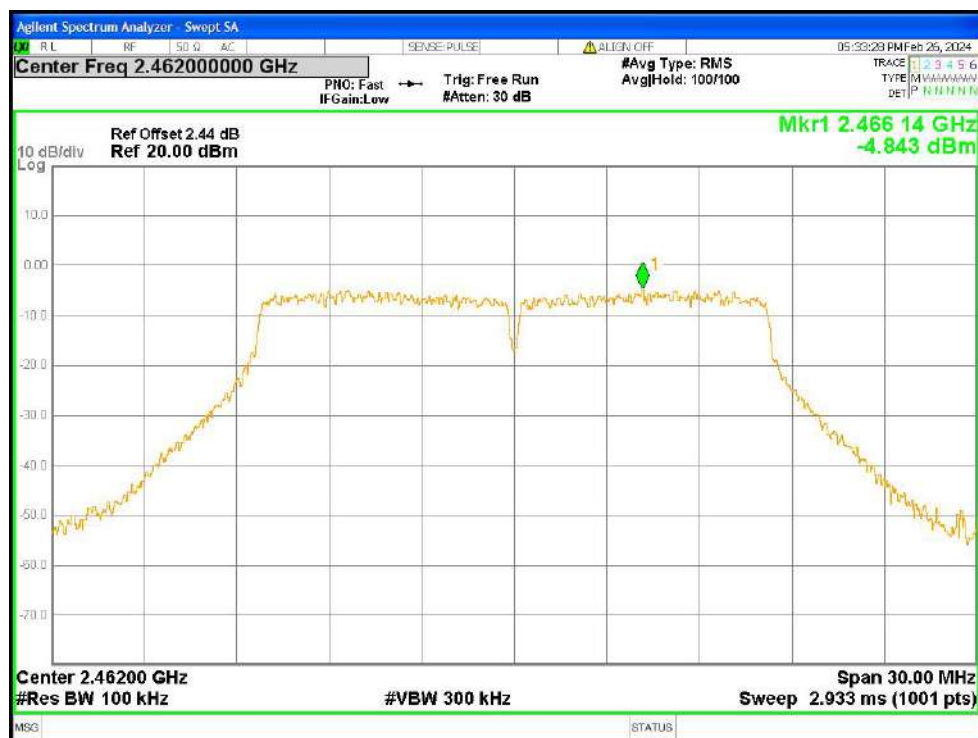
Band Edge NVNT g 2462MHz Ant0 Ref
