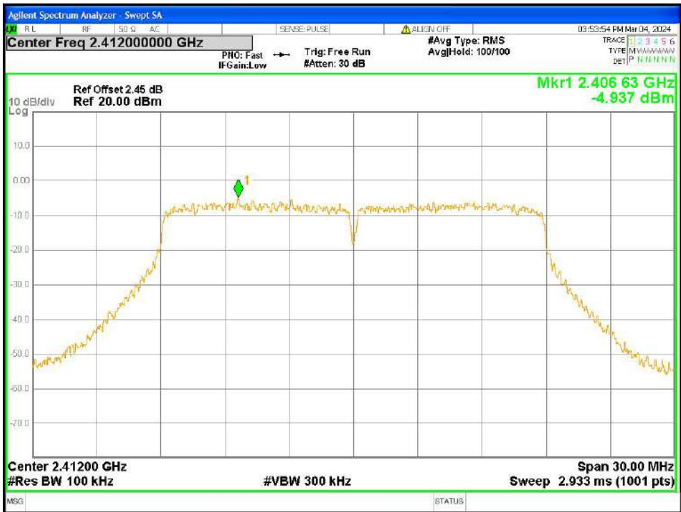
Band Edge NVNT n20 2412MHz Ant1 Ref
