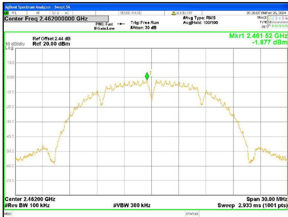
Band Edge NVNT b 2462MHz Ant0 Ref
