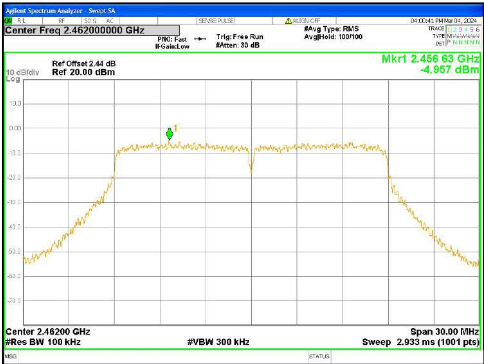
Band Edge NVNT n20 2462MHz Ant1 Ref
