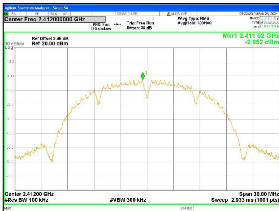
Band Edge NVNT b 2412MHz Ant0 Ref
