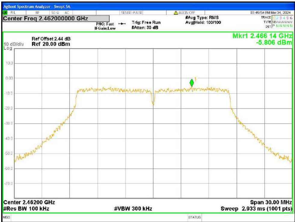
Band Edge NVNT g 2462MHz Ant1 Ref
