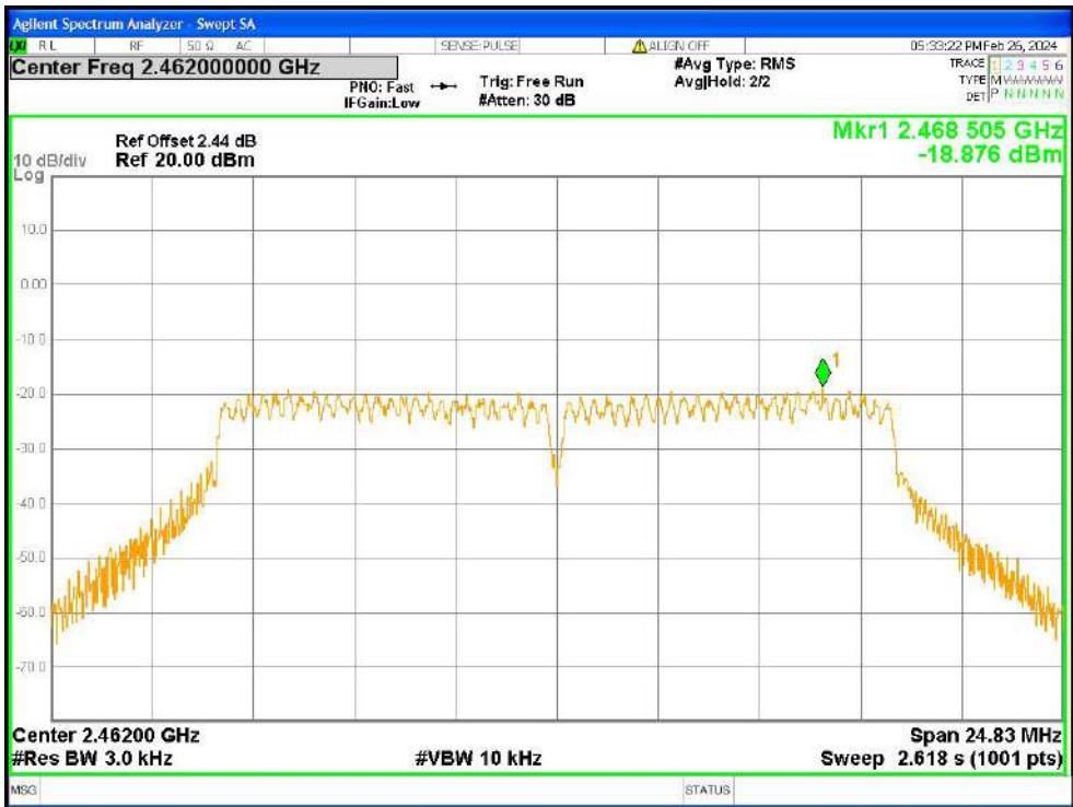
PSD NVNT g 2462MHz Ant0
