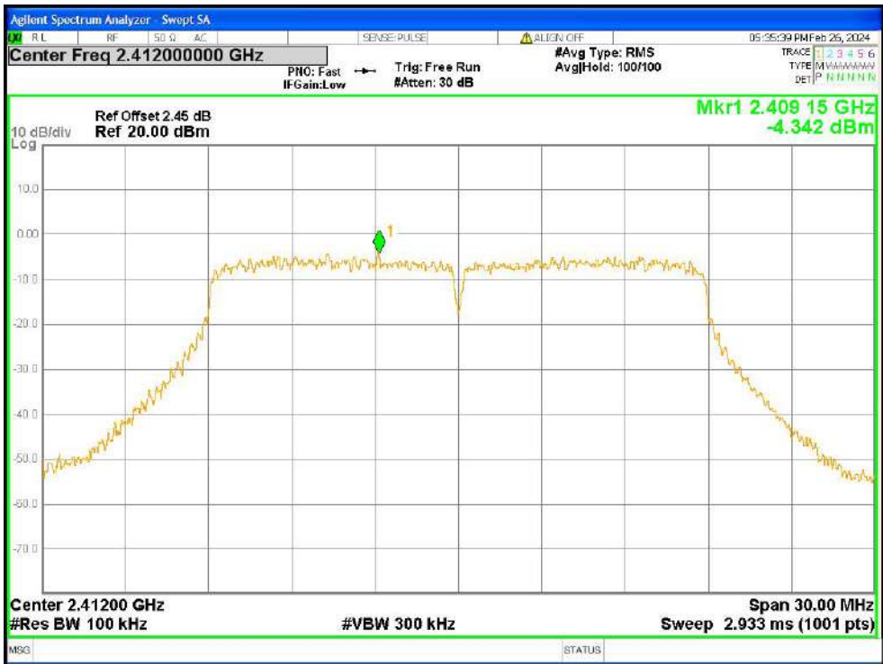
Band Edge NVNT n20 2412MHz Ant0 Ref
