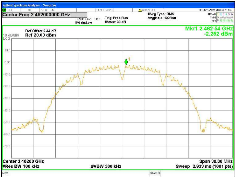
Band Edge NVNT b 2462MHz Ant1 Ref
