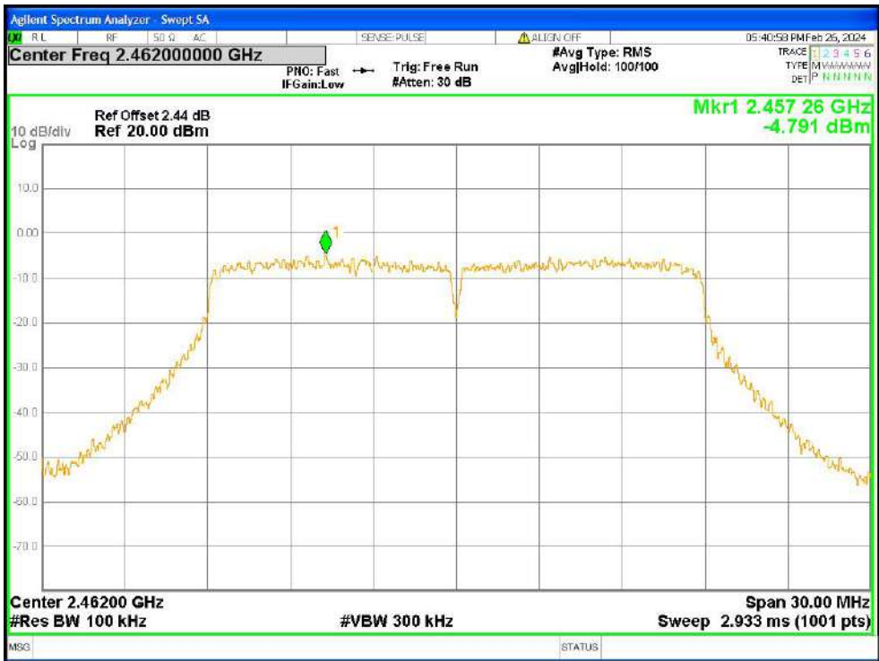
Band Edge NVNT n20 2462MHz Ant0 Ref
