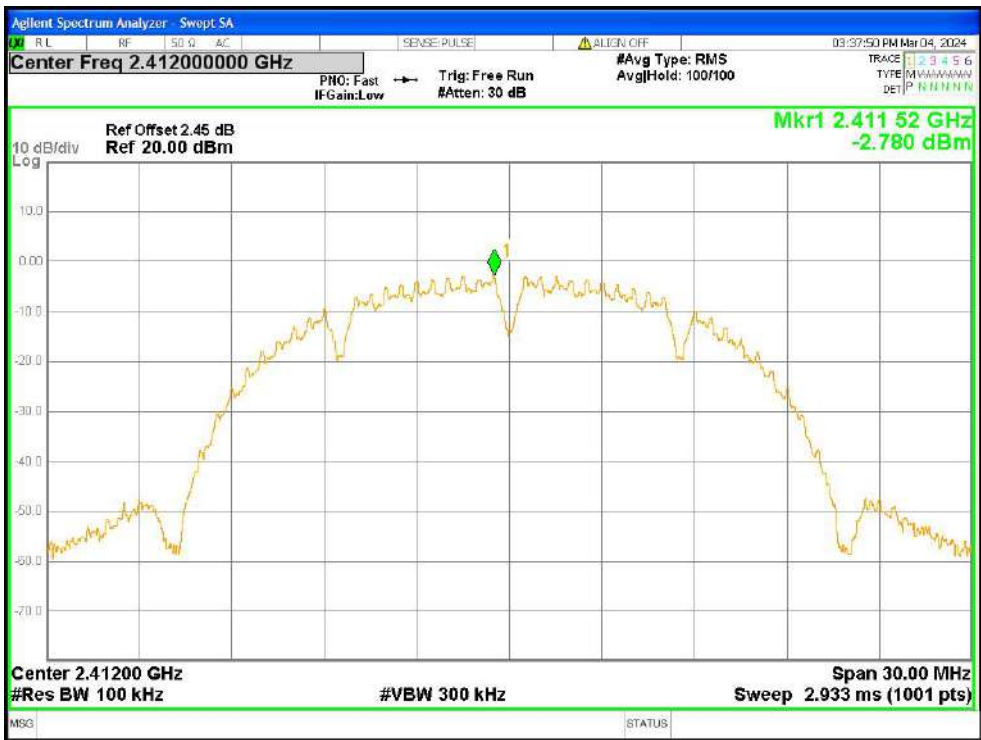
Band Edge NVNT b 2412MHz Ant1 Ref
