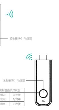
1. 请按住接收器功能键3秒钟以上, 界面弹出提示语: Release the button to pair with EZCast TX。等待发射器进入配对模式。
