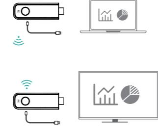
1. 将接收器的HD口连接到显示器或电视等显示设备的视频输入口。
