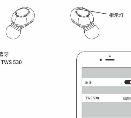
注:如果左右耳机在1分钟内未完成互连, 耳机将进入待机状态, 如有必要, 请关闭耳机后重复上述步骤重新连接。
