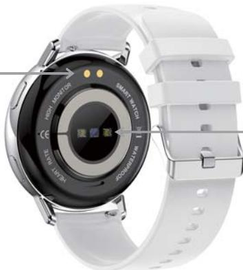
Contactos de carga de batería magnéticos
