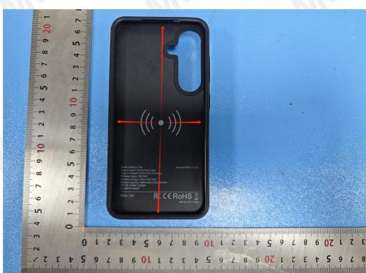
Transmitter to top:  $2 \pm 0.5\text{mm}$
