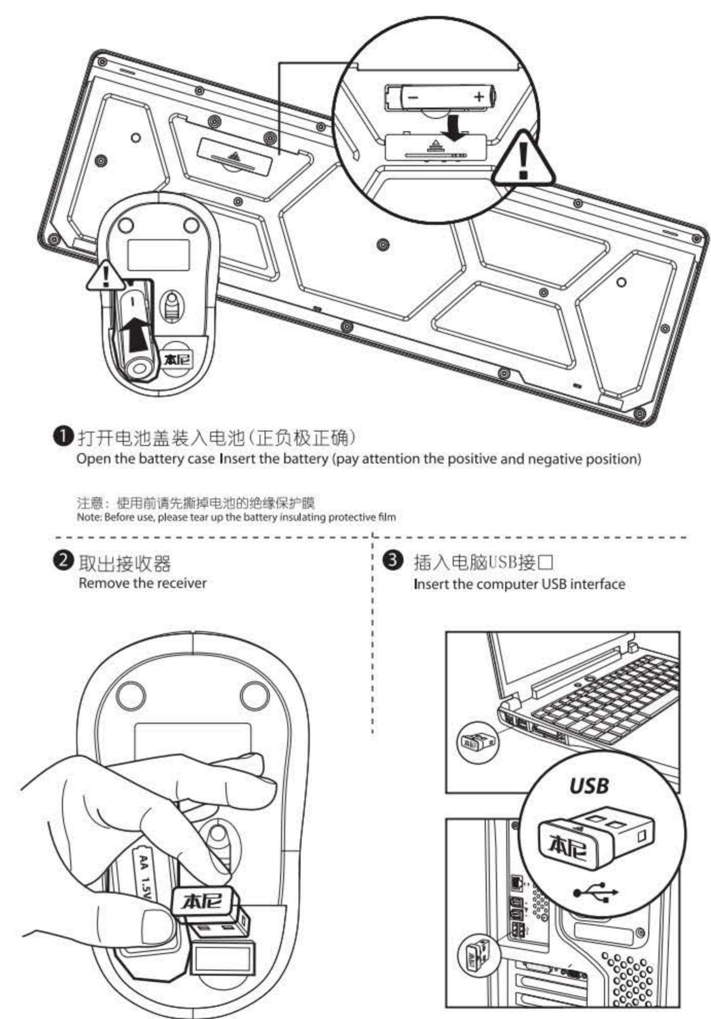
① 打开电池盖装入电池(正负极正确)
