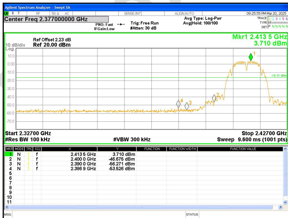
Band Edge NVNT b 2462MHz Ant2 Ref
