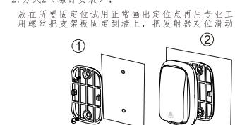
特别提示: 请避免安装在金属物(铁门, 铁窗等)上, 以免影响发射距离。固定前请试用可行与否。
