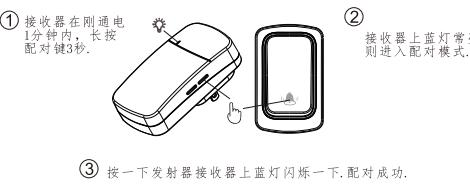
2. 清除对码: 如图示接收器在刚通电1分钟内长按接收器上按键不放到指示灯常亮后闪3下, 即清除掉所有对码。
