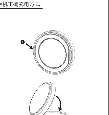
① 按箭头指示,从扣位处把产品支架打开,产品支架调整至合适的角度,将带有磁吸无线充电功能的手机放置在充电板上,充电板会自动吸附对位,可任意调整手机充电角度。
