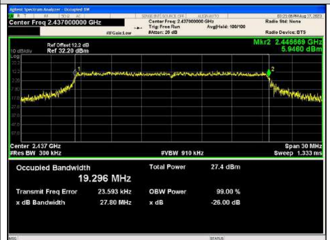
IEEE 802.11ax_Channel 6_20MHz_Antenna 0_RU&Index SU
