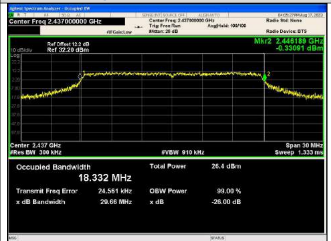
IEEE 802.11n_Channel 6_20MHz_Antenna 0
