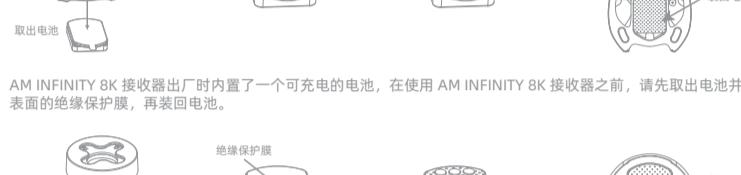
AM INFINITY 8K 接收器出厂时内置了一个可充电的电池，在使用 AM INFINITY 8K 接收器之前，请先取出电池并移除表面的绝缘保护膜，再装回电池。
