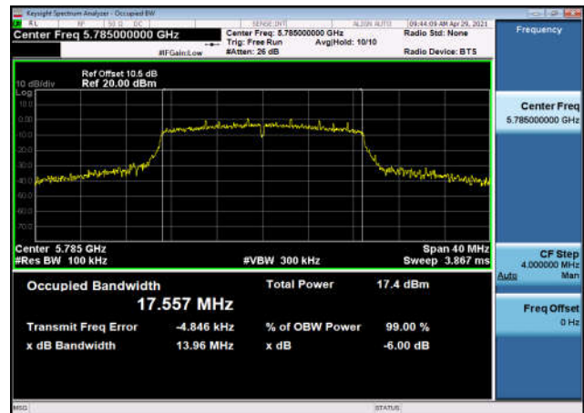
U-NII-3 6dB Bandwidth-802.11n(40MHz) ,5755MHz,Ant1
