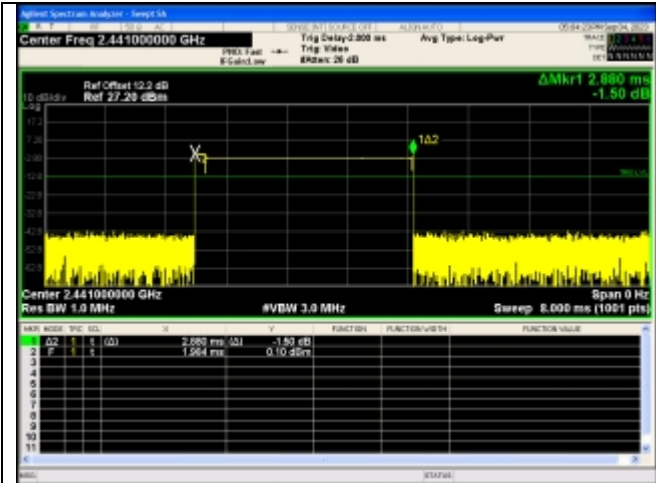
Pulse Width \pi/4 DQPSK_2-DH5
