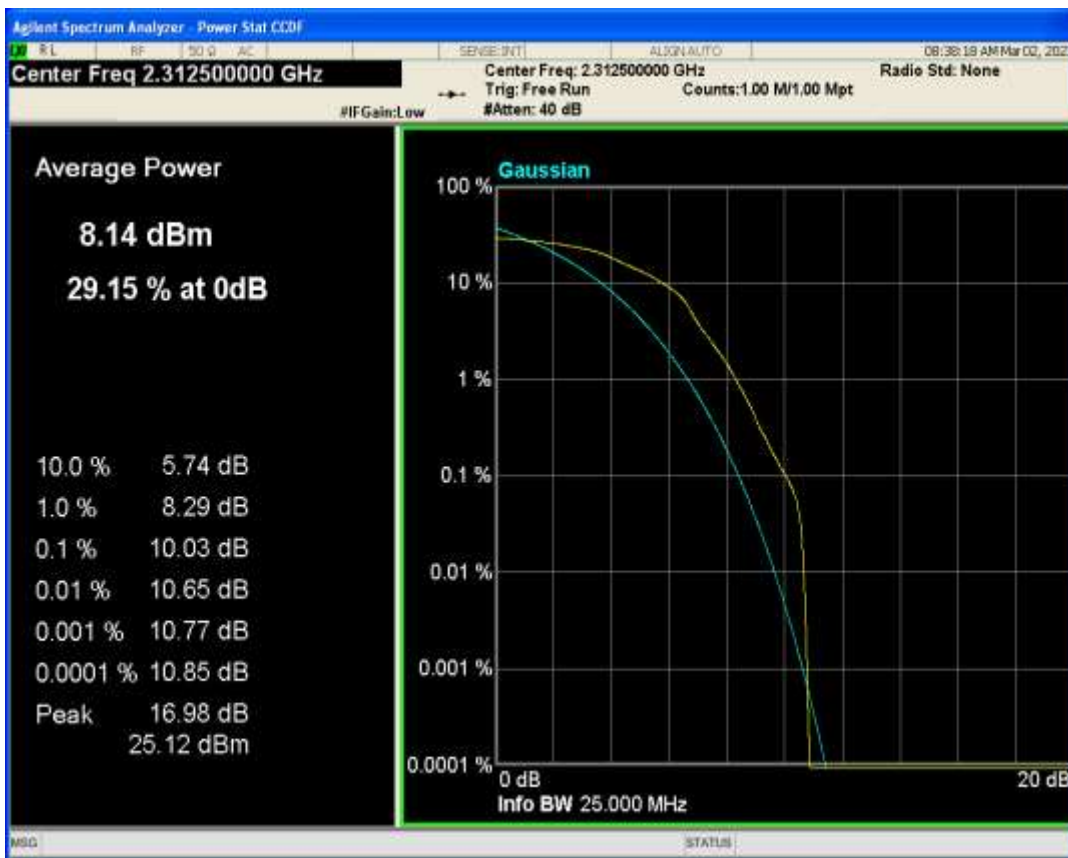
Band40(2305-2315) QPSK BW=10MHz Channel=38750 RB Size=1 Position=#0
