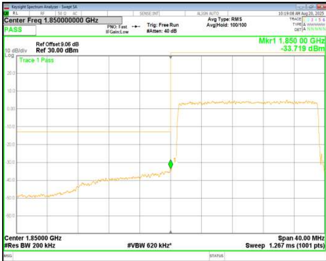
Band2 16QAM BW=20MHz Channel=18700 RB Size=100 Position=#0
