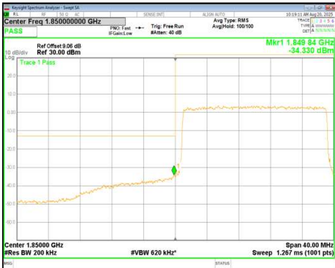
Band2 QPSK BW=20MHz Channel=19100 RB Size=100 Position=#0
