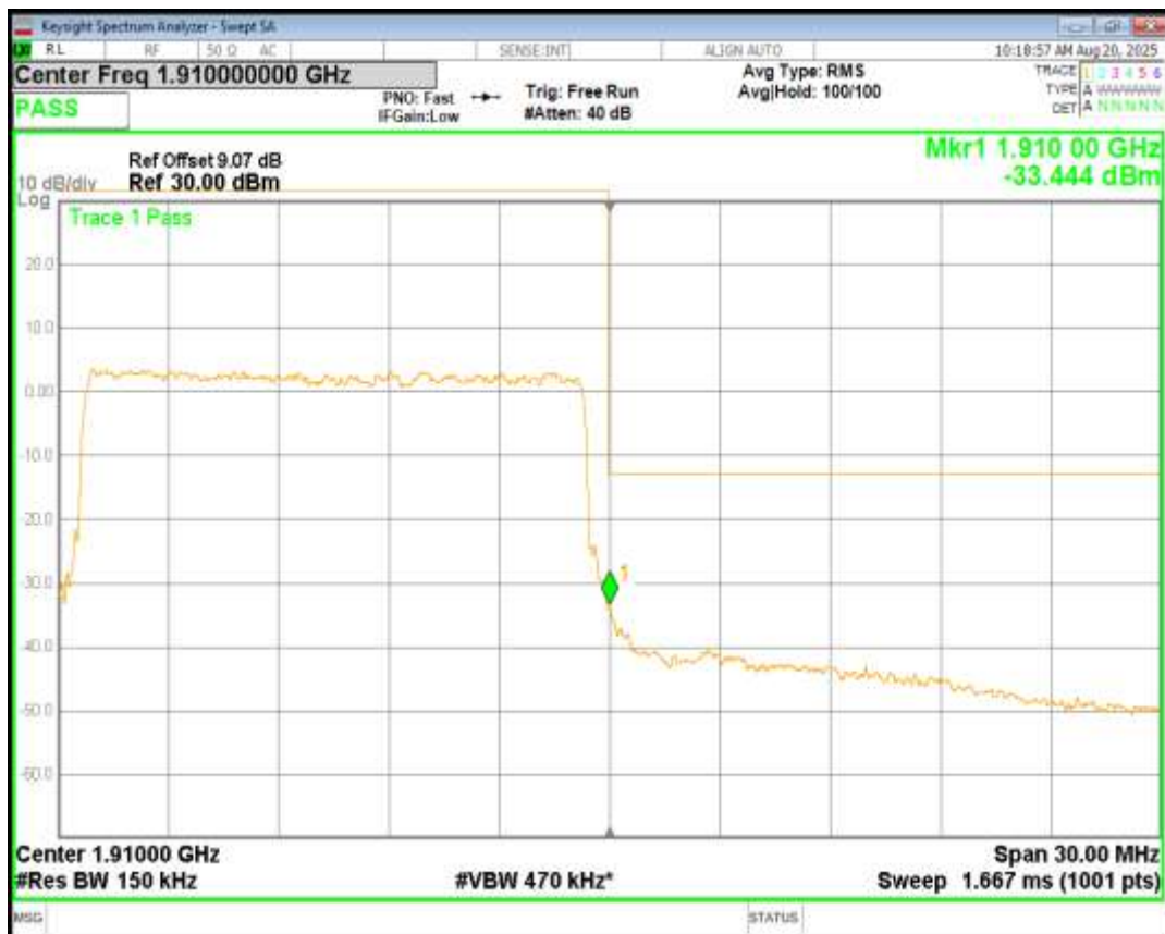
Band2 QPSK BW=20MHz Channel=18700 RB Size=100 Position=#0
