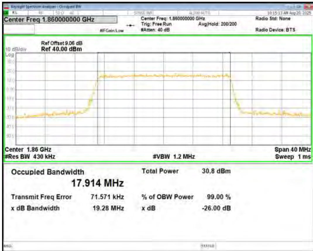
Band2 16QAM BW=20MHz Channel=18700 RB Size=100 Position=#0
