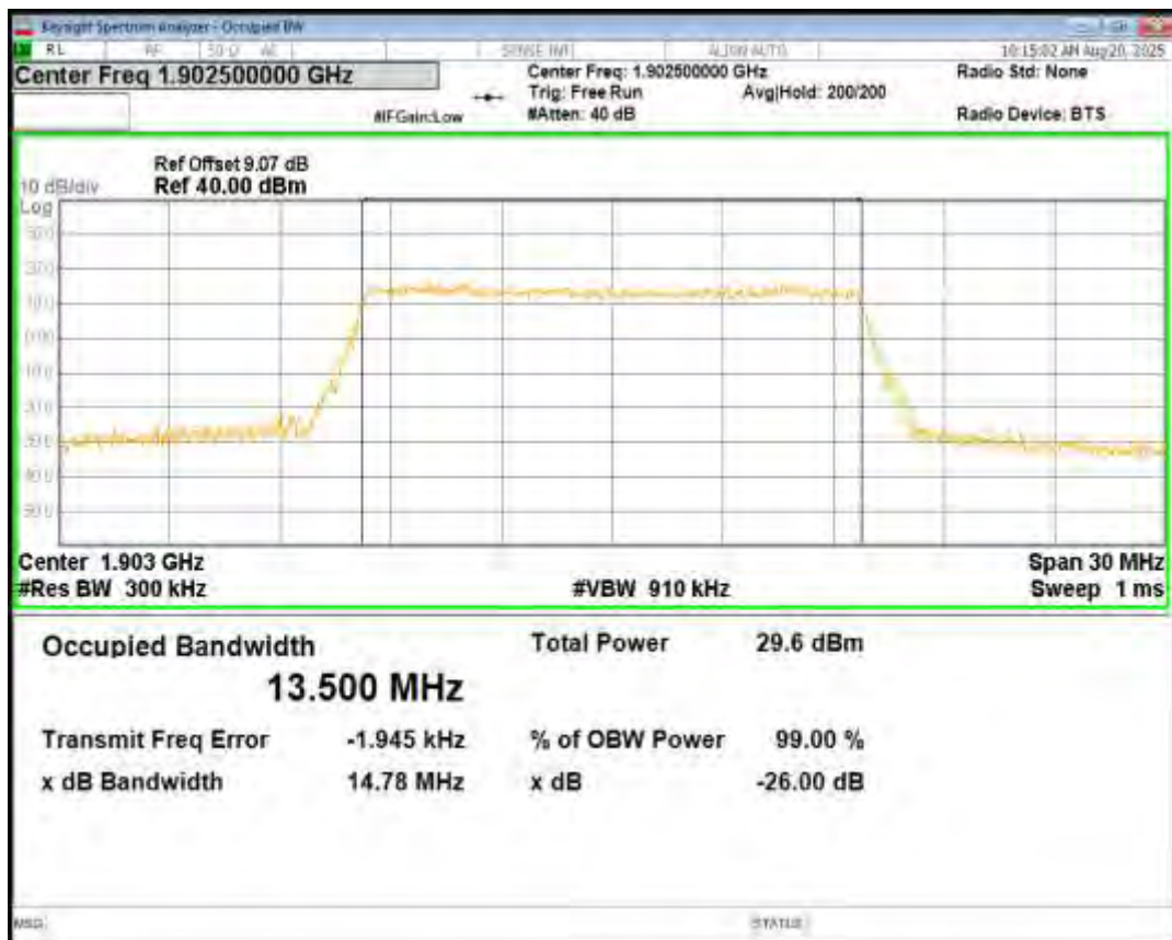
Band2 QPSK BW=20MHz Channel=18700 RB Size=100 Position=#0
