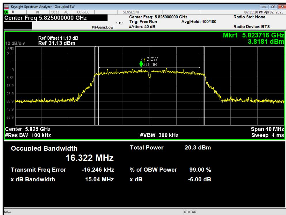
**-6dB Bandwidth 802.11ac(VHT20) 5745MHz**
