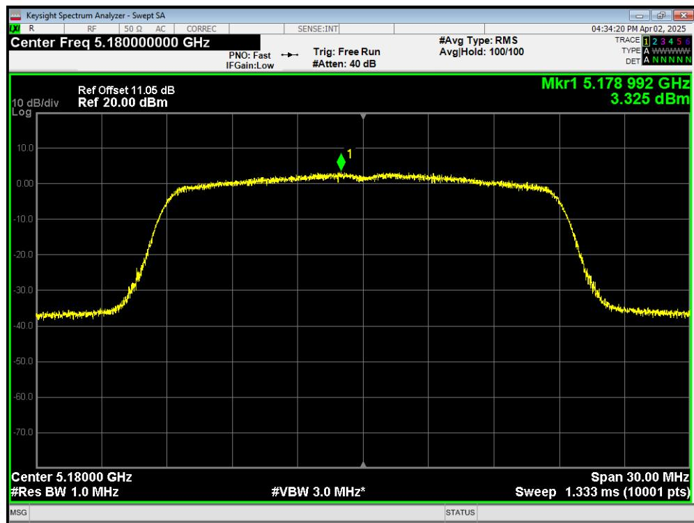
**PSD 802.11ac(VHT20) 5200MHz**
