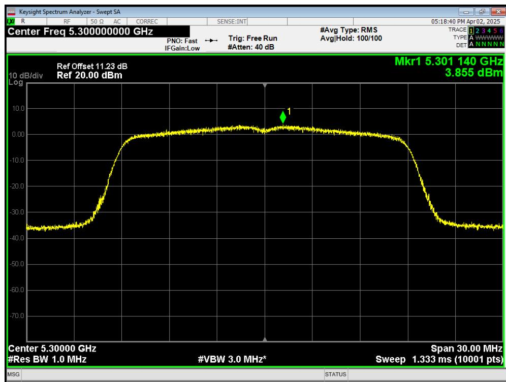
**PSD 802.11ac(VHT20) 5320MHz**
