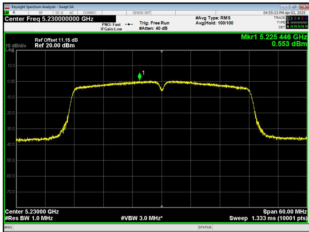
**PSD 802.11ac(VHT80) 5210MHz**
