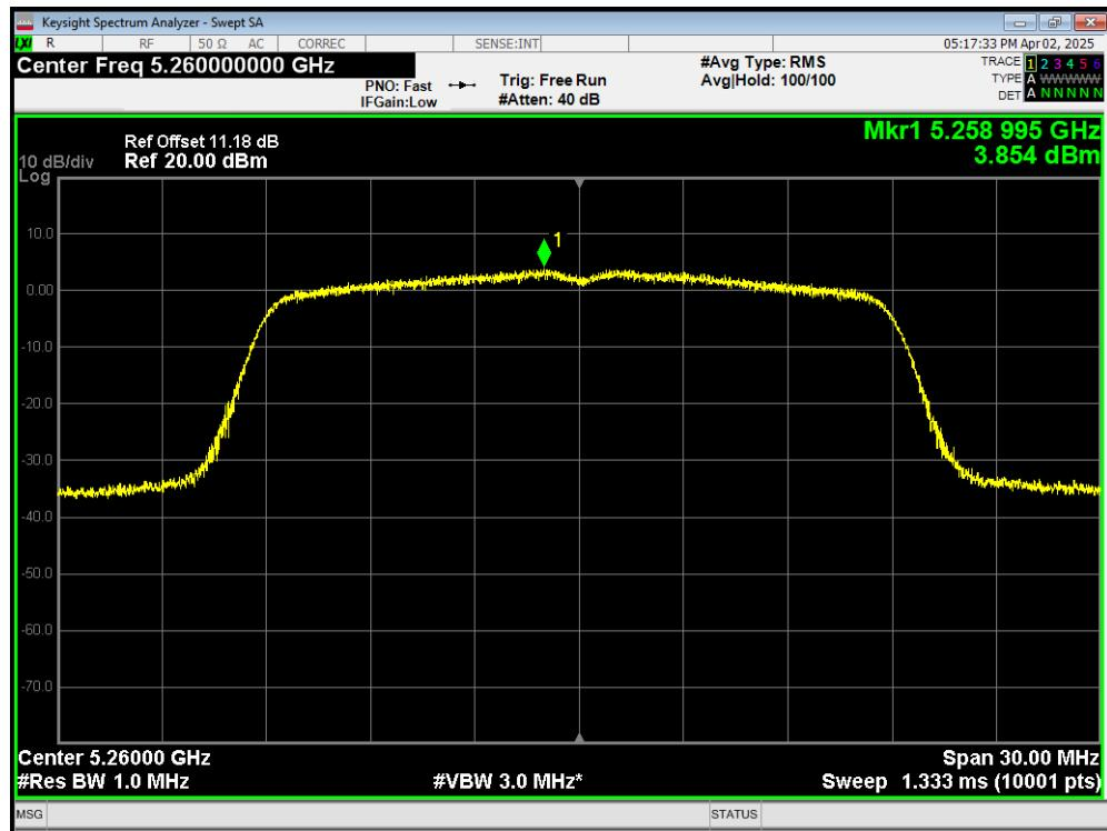
**PSD 802.11ac(VHT20) 5300MHz**
