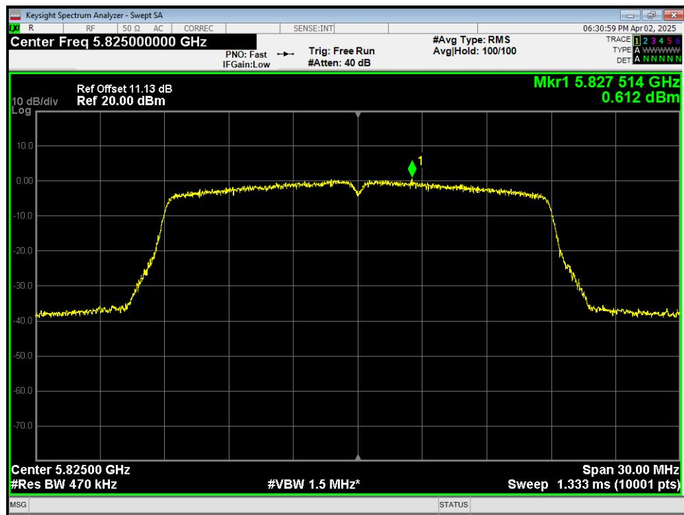
**PSD 802.11ac(VHT40) 5755MHz**
