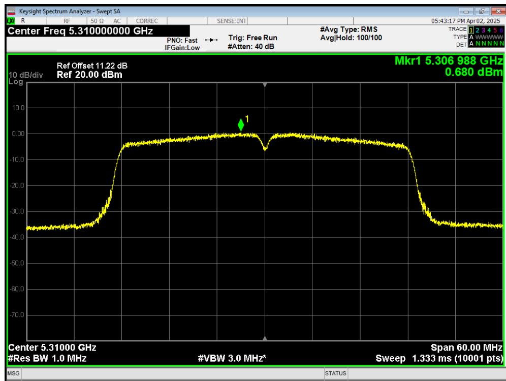
**PSD 802.11ac(VHT80) 5290MHz**
