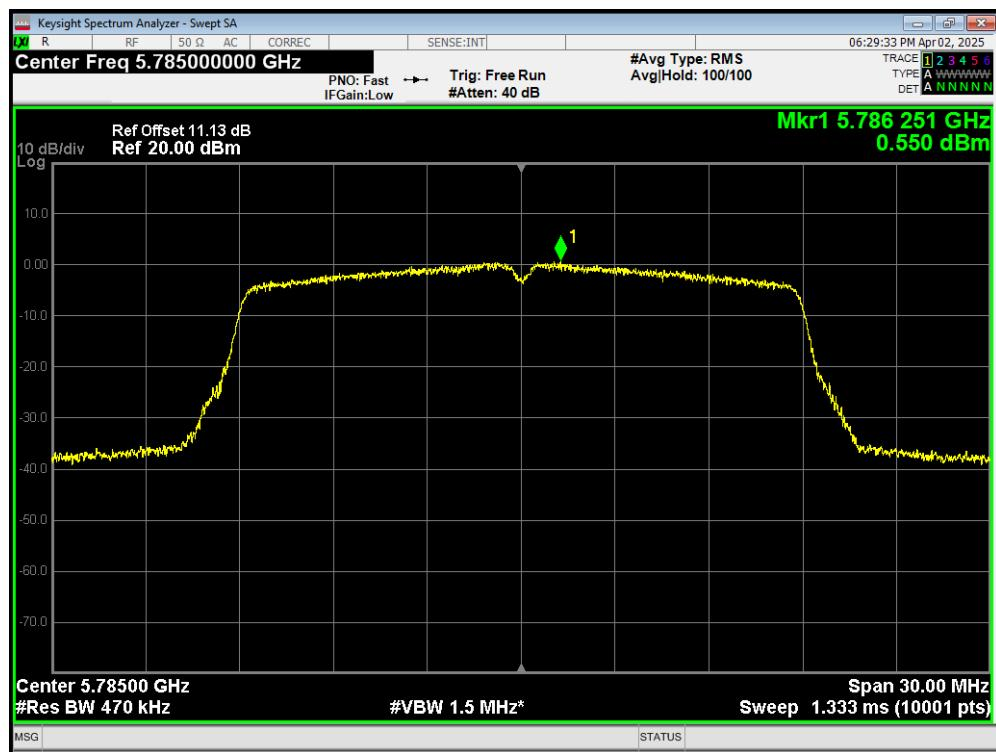
**PSD 802.11ac(VHT20) 5825MHz**
