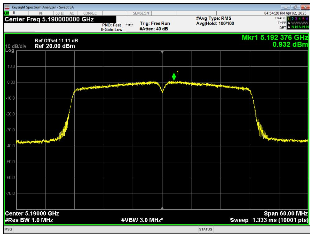
**PSD 802.11ac(VHT40) 5230MHz**
