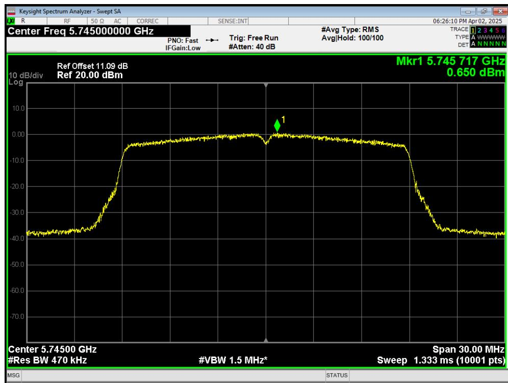
**PSD 802.11ac(VHT20) 5785MHz**
