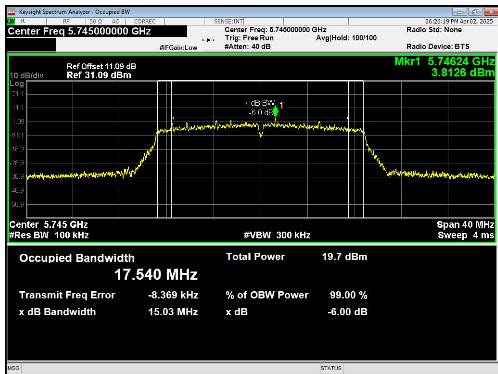
**-6dB Bandwidth 802.11ac(VHT20) 5785MHz**
