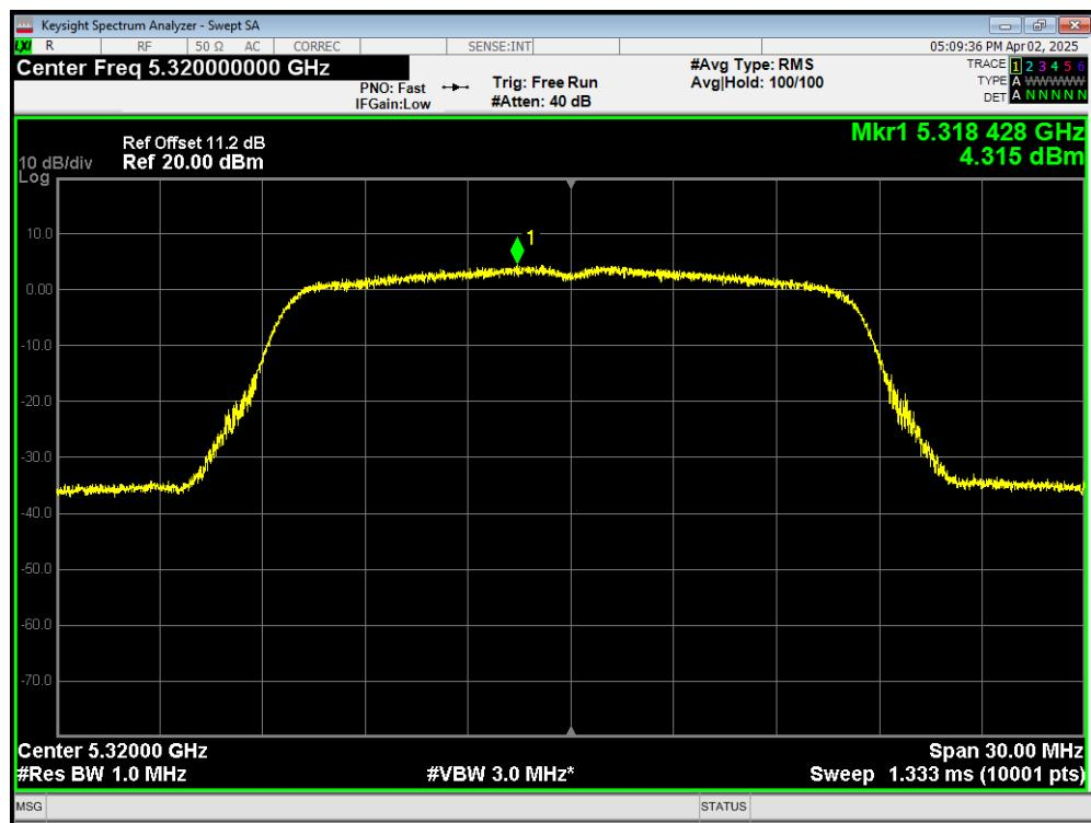
**PSD 802.11ac(VHT20) 5260MHz**
