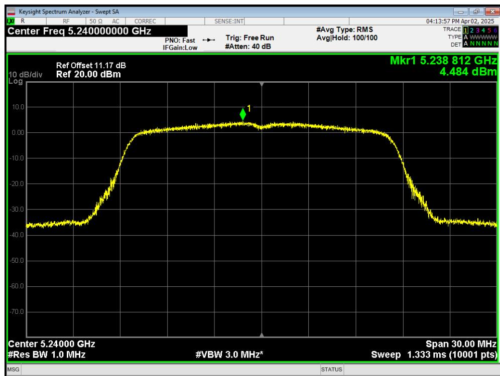
**PSD 802.11ac(VHT20) 5180MHz**
