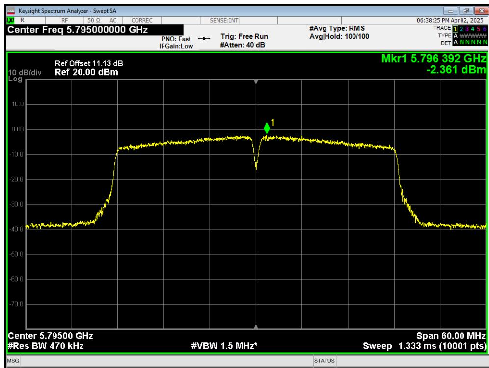
**PSD 802.11ac(VHT80) 5775MHz**
