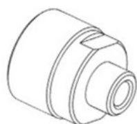
Adaptador A – para liberação rápida porca do cassete
