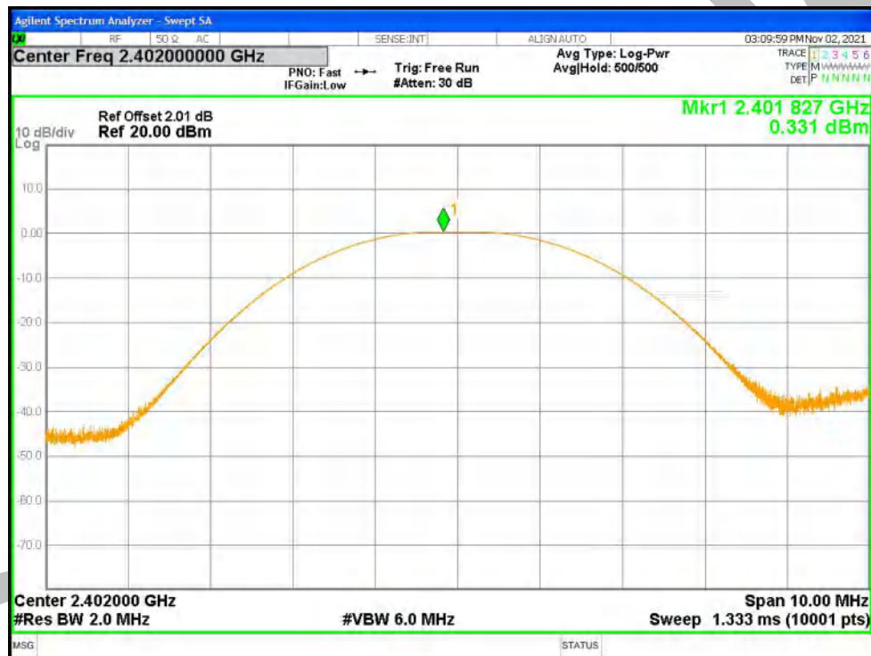
Power NVNT BLE 1M 2402MHz Ant1
