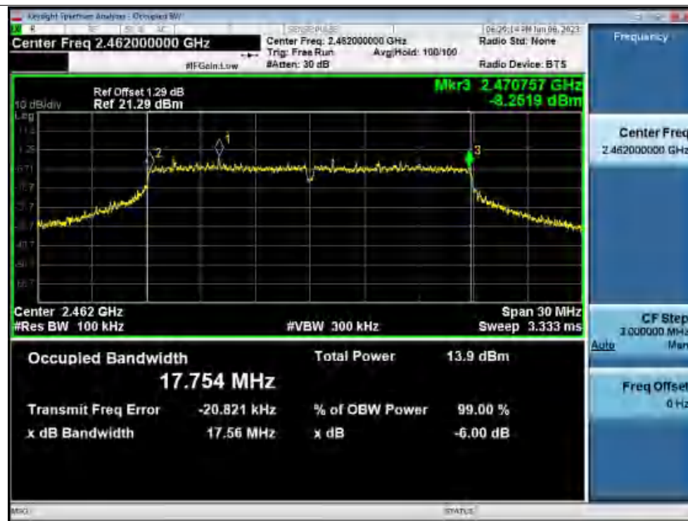
-6dB Bandwidth NVNT g 2462MHz Ant1
