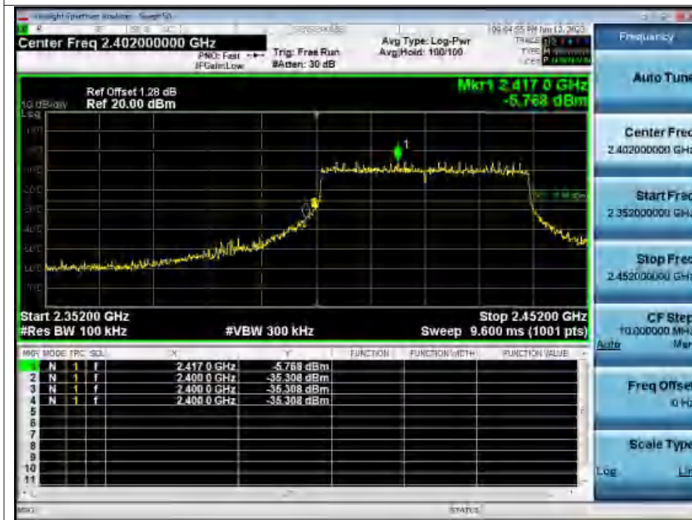
Band Edge NVNT ax40 2422MHz Ant1 Emission
