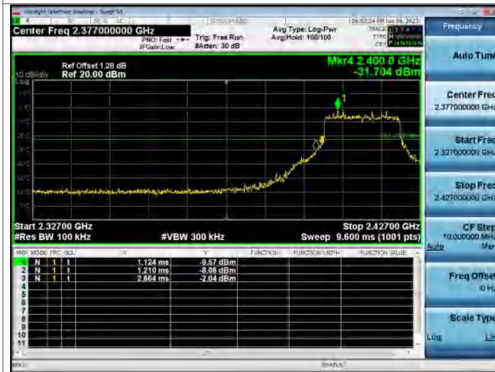
Band Edge NVNT ax20 2412MHz Ant1 Emission
