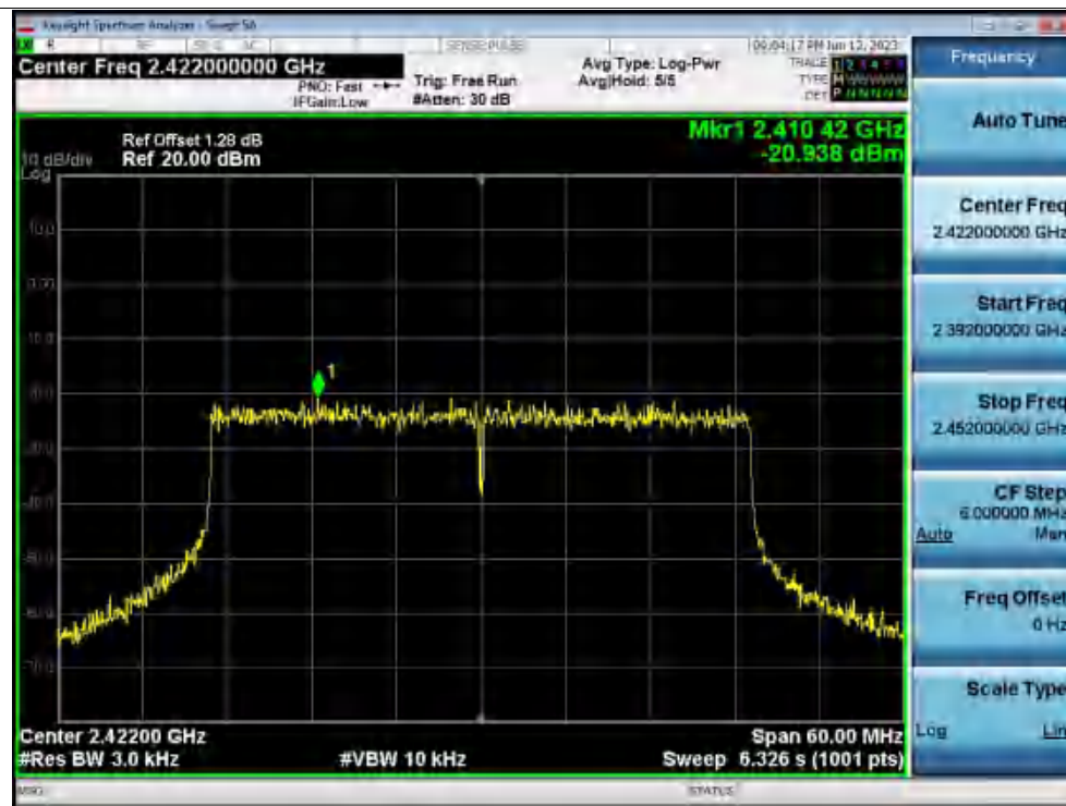
PSD NVNT ax40 2422MHz Ant1
