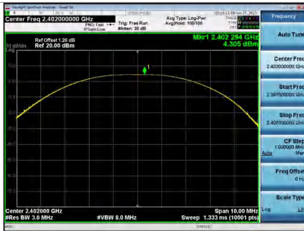
Power NVNT BLE 2M 2402MHz Ant1
