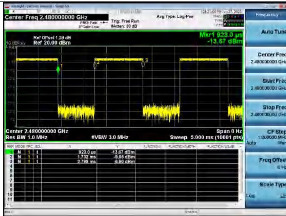
Duty Cycle NVNT BLE 2M 2480MHz Ant1
