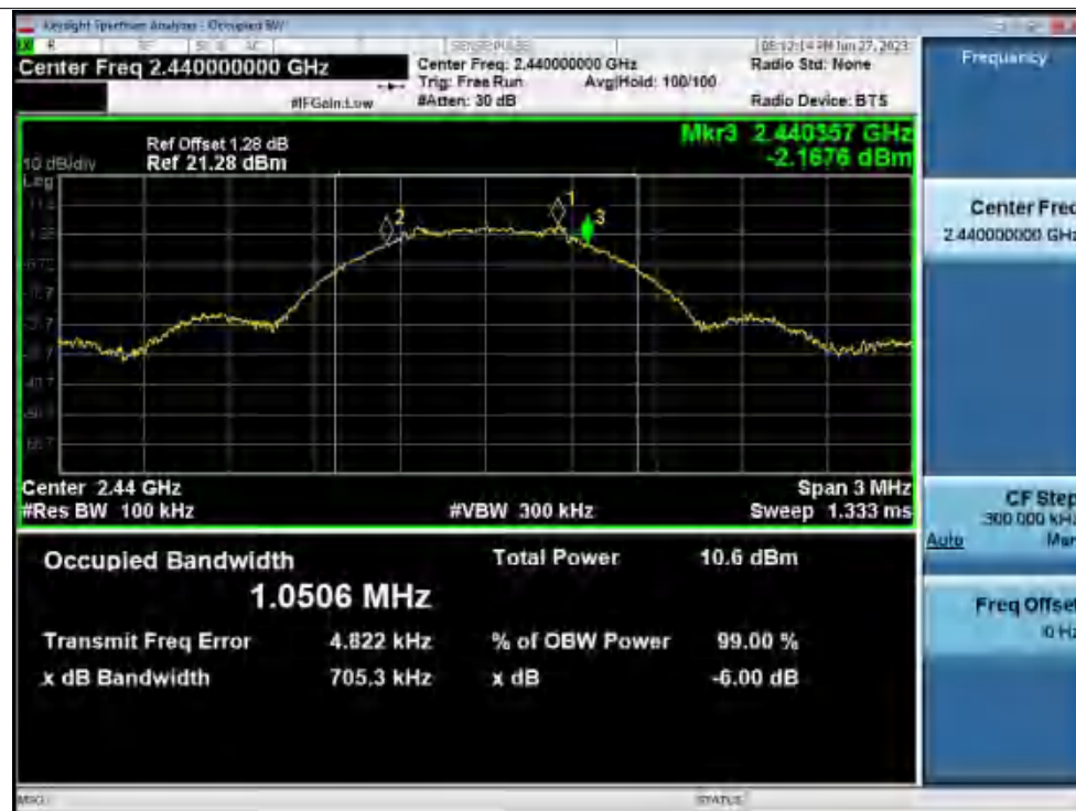
-6dB Bandwidth NVNT BLE 1M 2440MHz Ant1
