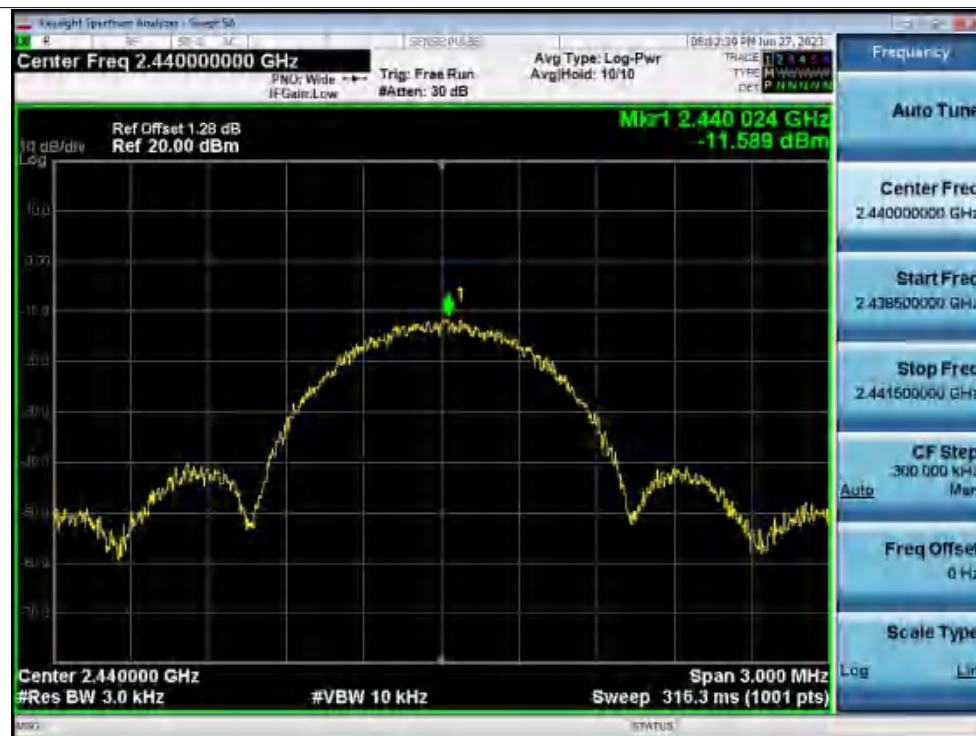
PSD NVNT BLE 1M 2440MHz Ant1
